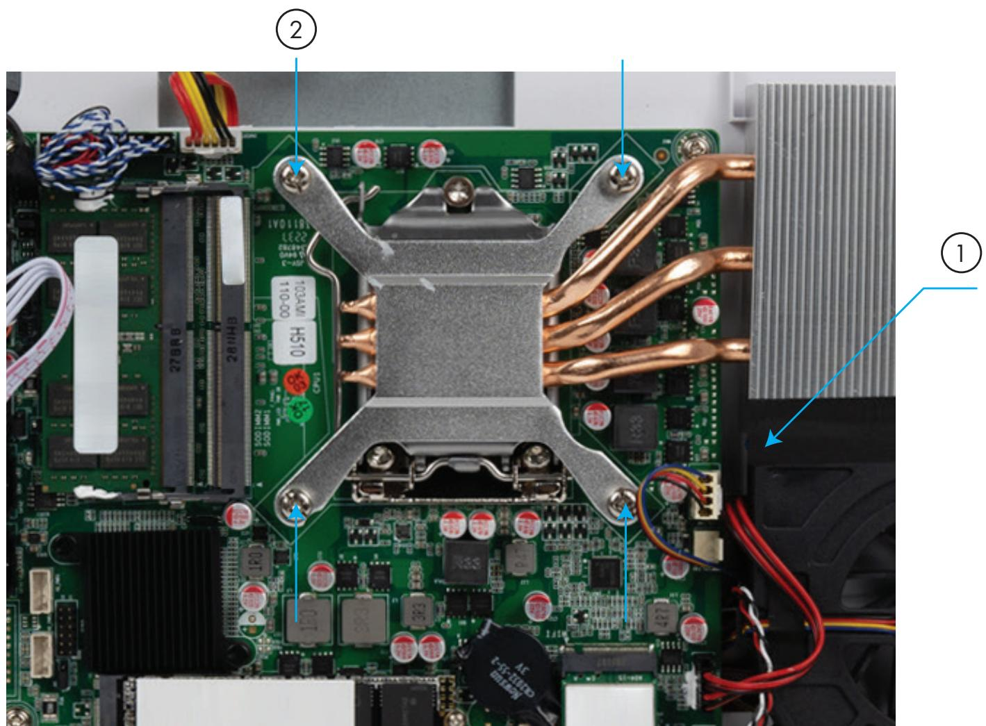
Отгибаем держатель рамки процессора в стороны и поднимаем вверх
