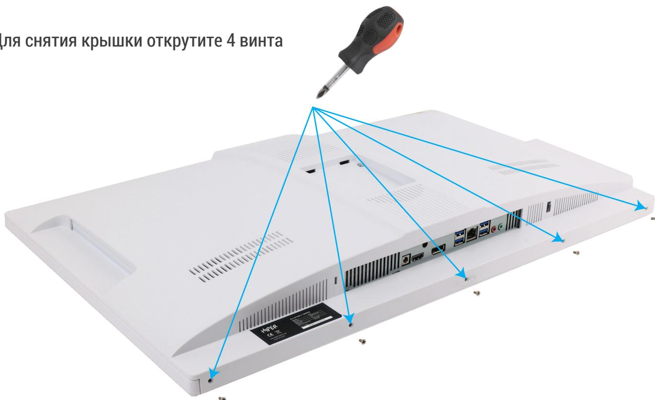
Затем сдвиньте крышку на себя (1) и поднимите её вверх (2)
