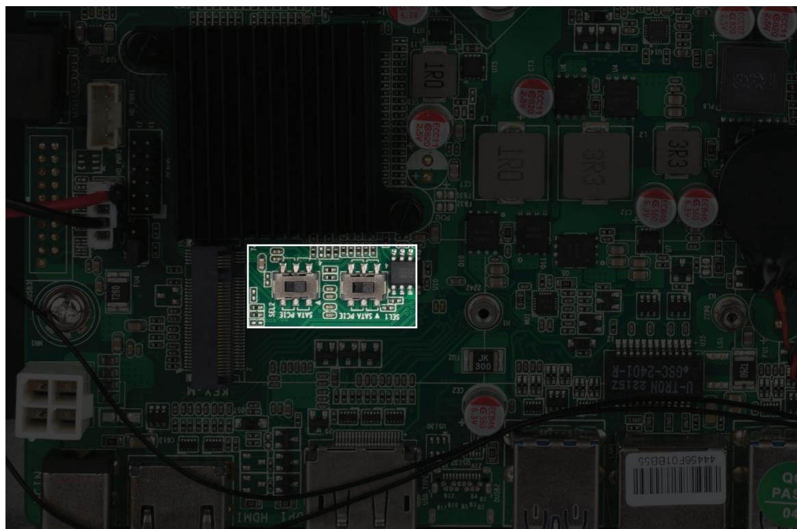
3) Вставьте разъём нового твердотельного накопителя в гнездо (1) на системной плате и закрепите его с помощью винта (2).
