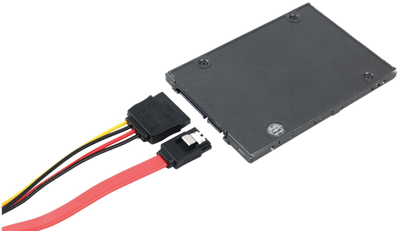
Подключаем кабели SATA к разъёмам на плате
